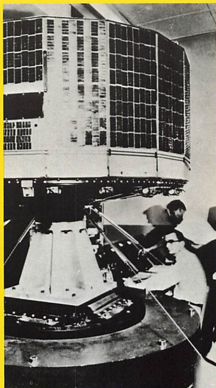
▲振動テストを受ける氣象衛星タイロス1号
